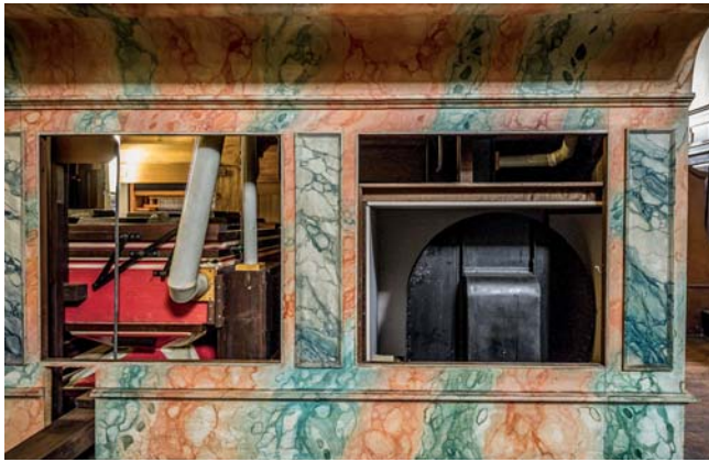
Windanlage mit Meidinger-Gebläse von 1930 und alternativ zu betätigendem, am Bildrand links unten erkennbarem Trethebel.
